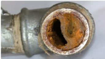
Tuyau présentant des dépôts de calcaire
