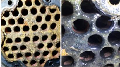
Faisceau tubulaire d'un échangeur de chaleur
