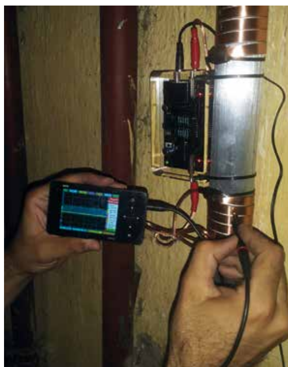
Évaluation du fonctionnement de Vulcan à l'aide du détecteur d'impulsions.
