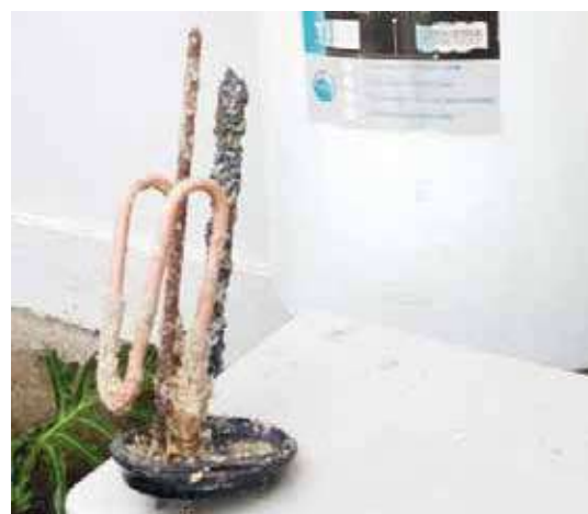
Le calcaire encore présent est mou et se rince facilement depuis l'installation du dispositif anti-calcaire électronique Vulcan.
