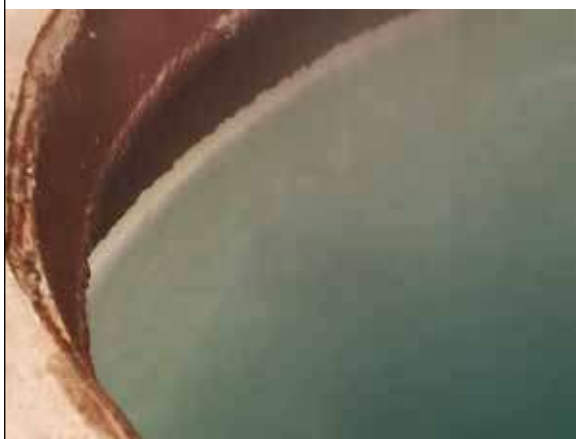
Avant l'installation de Vulcan, le réservoir d'eau chaude était recouvert de calcaire dur, très difficile à éliminer.
